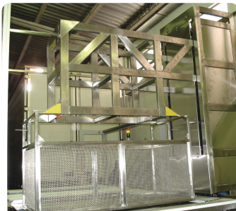
LINHA AUTOMATIZADA COM 03 TANQUES E ROBÔ COM CAPACIDADE DE CARGA PARA 500Kg
