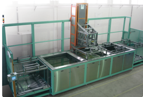
LINHA AUTOMATIZADA COM 03 TANQUES E ROBÔ COM CAPACIDADE DE CARGA PARA 500Kg
