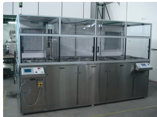
LINHA AUTOMATIZADA COM 12 TANQUES PARA LIMPEZA DE LENTES QUE SERÃO SUBMETIDAS AO TRATAMENTO ANTI-REFLEXO
