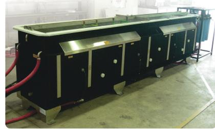
TANQUE DE LIMPEZA POR ULTRASSOM COM CAPACIDADE PARA 5.000L
